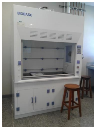
Figura 7.2. Capilla extractora de gases.
